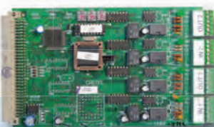
MIRFO Interface permettant de relier une centrale Maylis à deux autres réseaux Maylis via une fibre optique REF 440.3800
